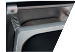
Vering om een maximale druk te realiseren op alle hoeken van de verpakking
